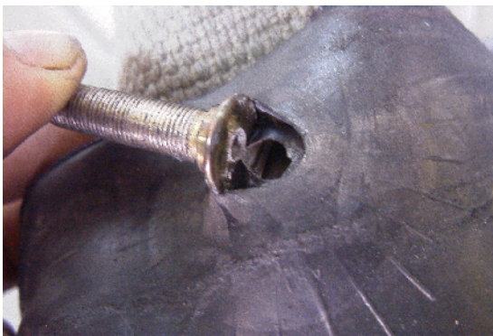
エアバルブ破損例
