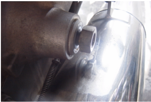
正常：ナットを緩めると隙間が出る
