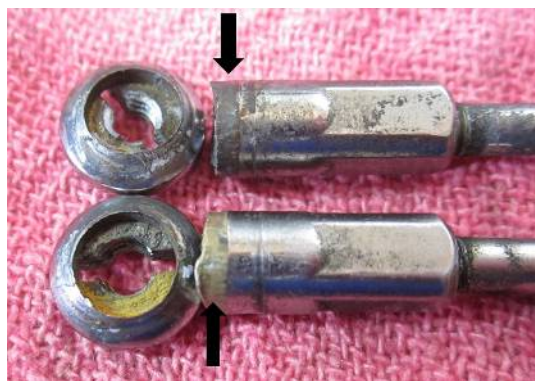
破断面側にメッキがない
