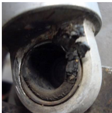
スペーサー剥離
