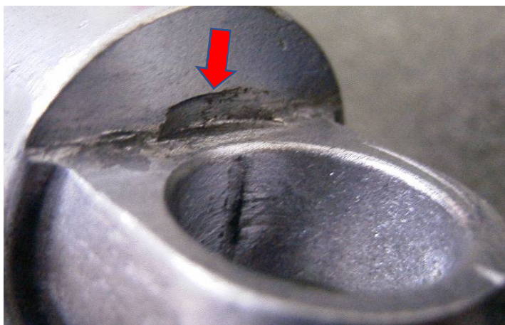
固定ボルトの大径ワッシャーがサス・ボディーと接触している
