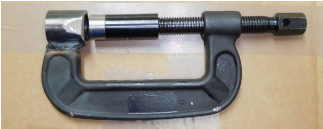
クリメカ特製脱着工具 (押しコマ先端部は焼き入れ処理)
