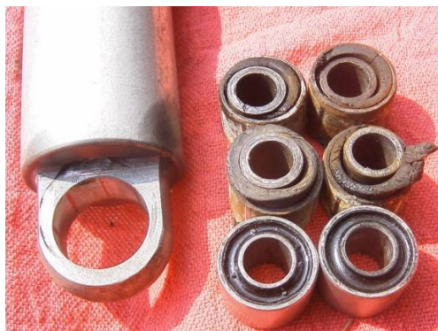
損傷品(上4個)と新品(下2個)
