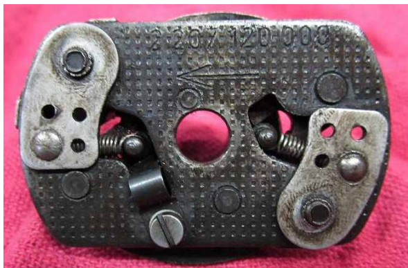
R50-69S用(CCW) 反時計回り 板バネが見えます
