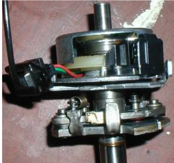
1981年→ 無接点式トリガー内部のガバナー(下部)
