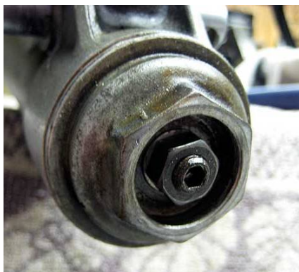
底部：ゴムキャップを外すとナットが見える
