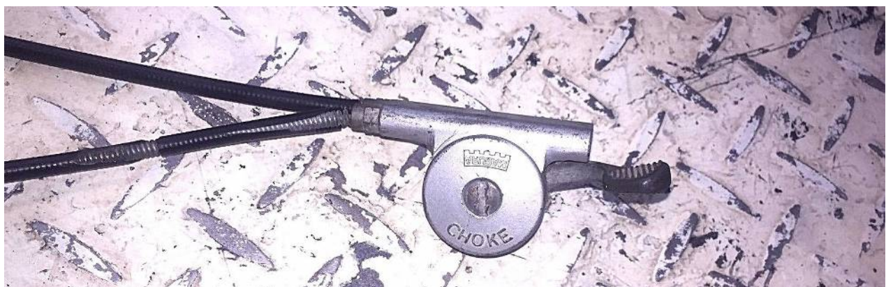
チョークケーブルは経年劣化やコックとの接触で被覆が損傷する
