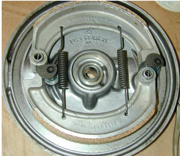
画像左が進行方向である 左が太いバネ/右が細いタイヤ
