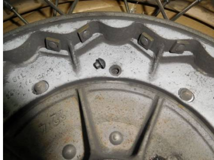
リベット脱落
