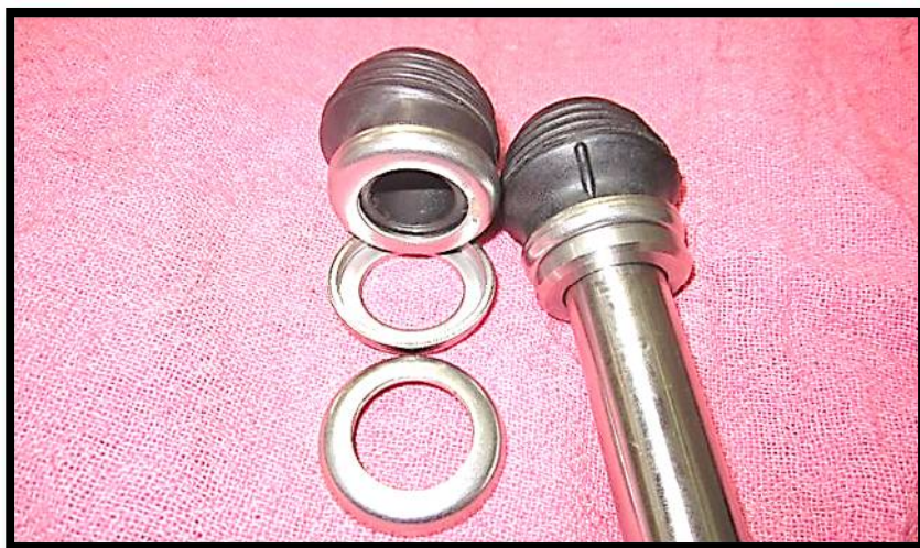
ステンレス製プッシュロッド・チューブとステンレス製シールサポート
