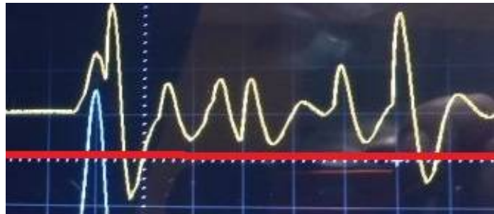
進角終了で波形が乱れトンチンカンな位置でストロボ発光することも
