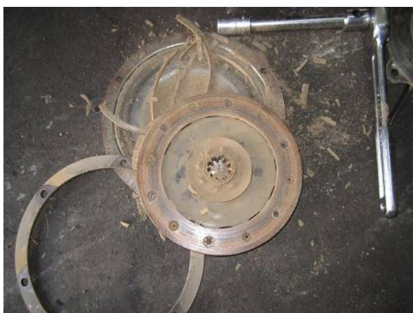
クラッシュしたクラッチ板(木工所の機械みたい)
