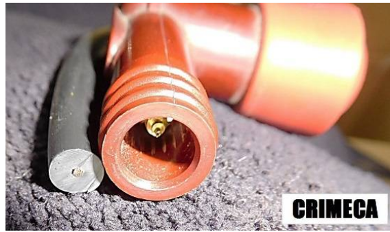
外径7ミリのコードにキャップを捻じ込みます
