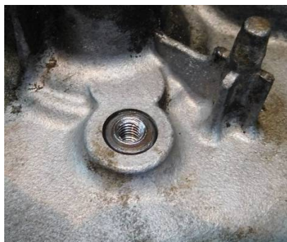
オイルの流れた痕跡が認められます
