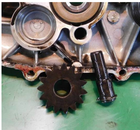
取り出したギアと段付き圧入ピン
