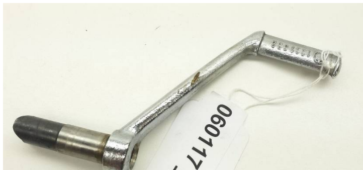
強度アップの対策品か？ オーバル断面に戻っている
