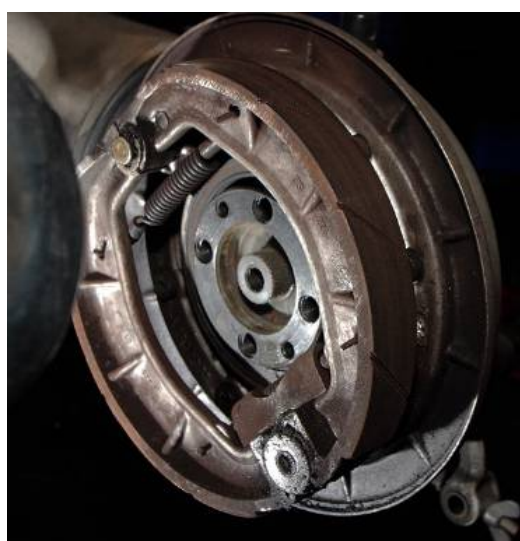
改良型 R100GS系 スプリングの装着方向が逆
