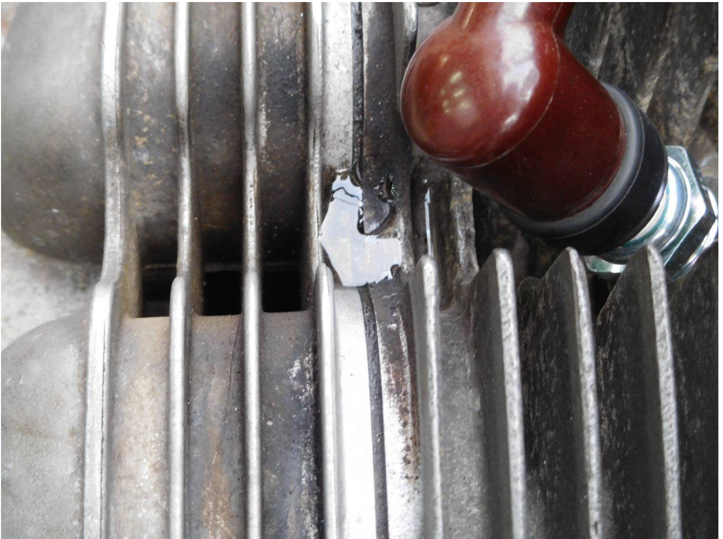
エンジン始動でポコポコ沸騰してドライになります 雨中走行が多いと泥、砂交じりの水が入るので小石が残ることも
