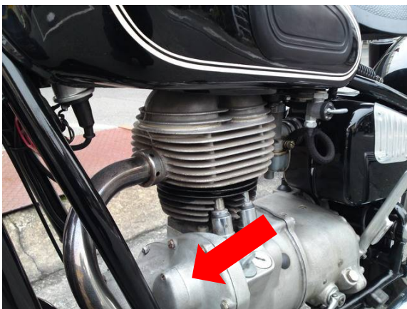
赤矢印がポイント部 点火コイルはようやくアウトドアへ 「32」がポイントカバー 先行モデルで懲りて電装はエンジン外部へ移設
