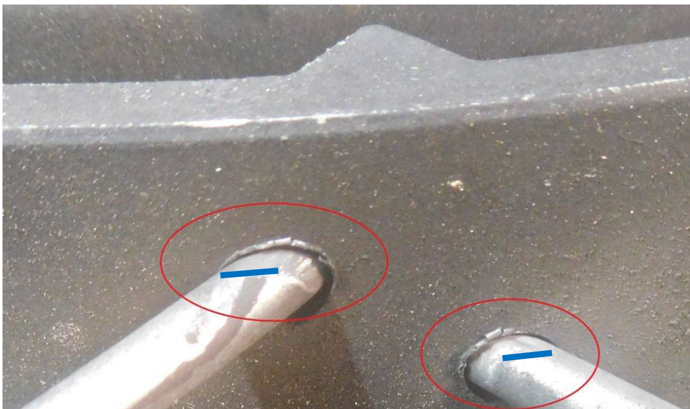
発進加速、減速、横Gで揉まれスポーク接触部は削られめくられ 元は青線の位置まで入っていたのかもしれませんが
