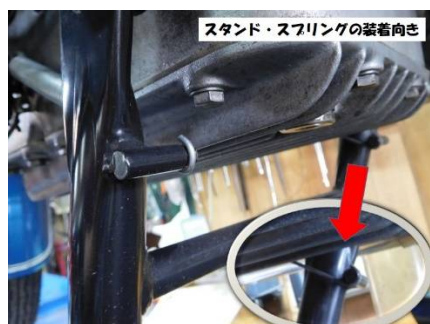
スプリングを左右ともこの向きで装着すると スタンドの戻りもスッキリしてバネも長持ち
