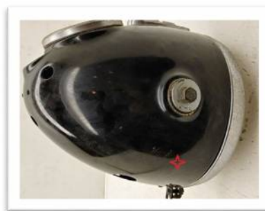
目立たなく加工しやすい位置に穴をあける メリットはウインカーのアースにもなる
