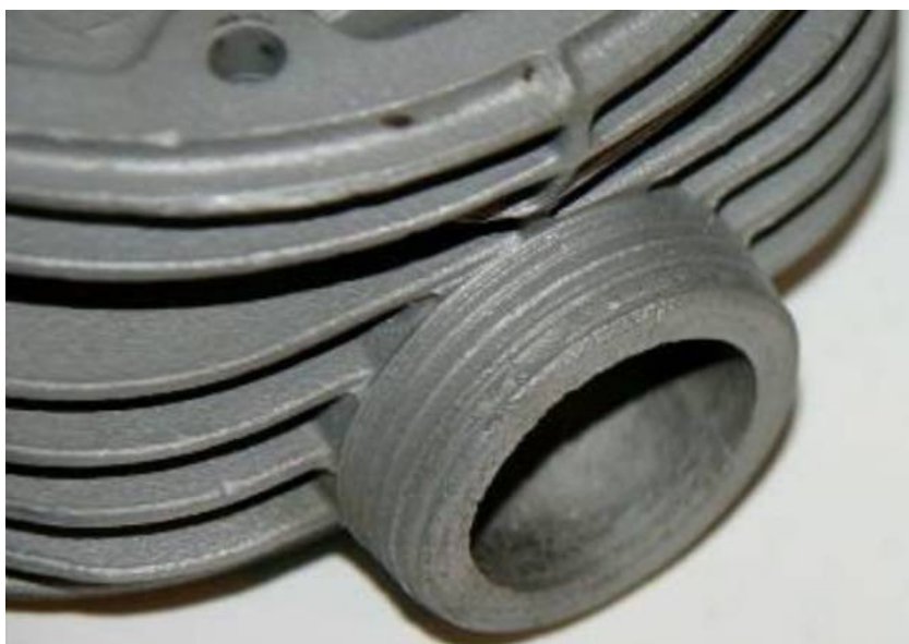
材質が柔らかいので排気管脱着の際に崩れる(コレはまだセーフ)
