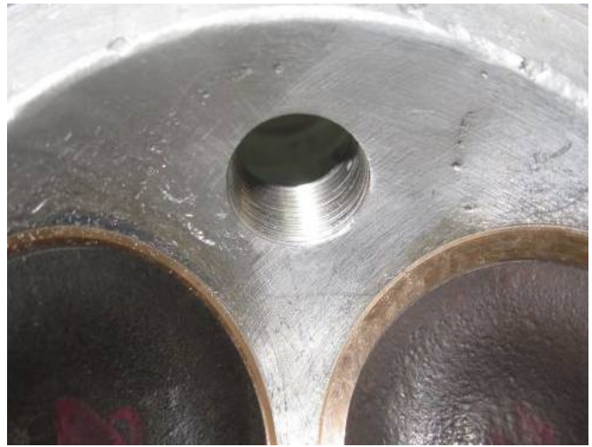
インサートを引き抜きアルゴン溶盛+ネジ山再生
