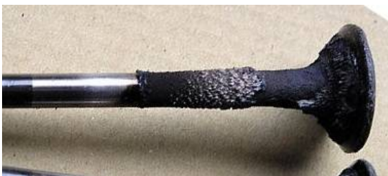
排気バルブは燃焼ガスに晒されるので堆積しやすい
