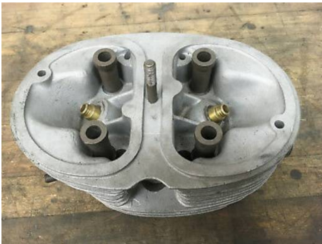
4本のスリーブはロッカーブロックをサポートする
