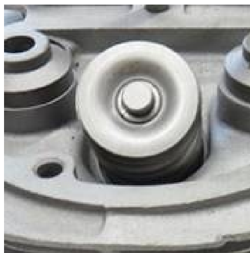
回転式のコッター(2R/3R)には隙間がない
