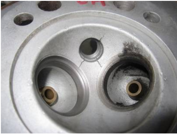
プラグホールのクラック
