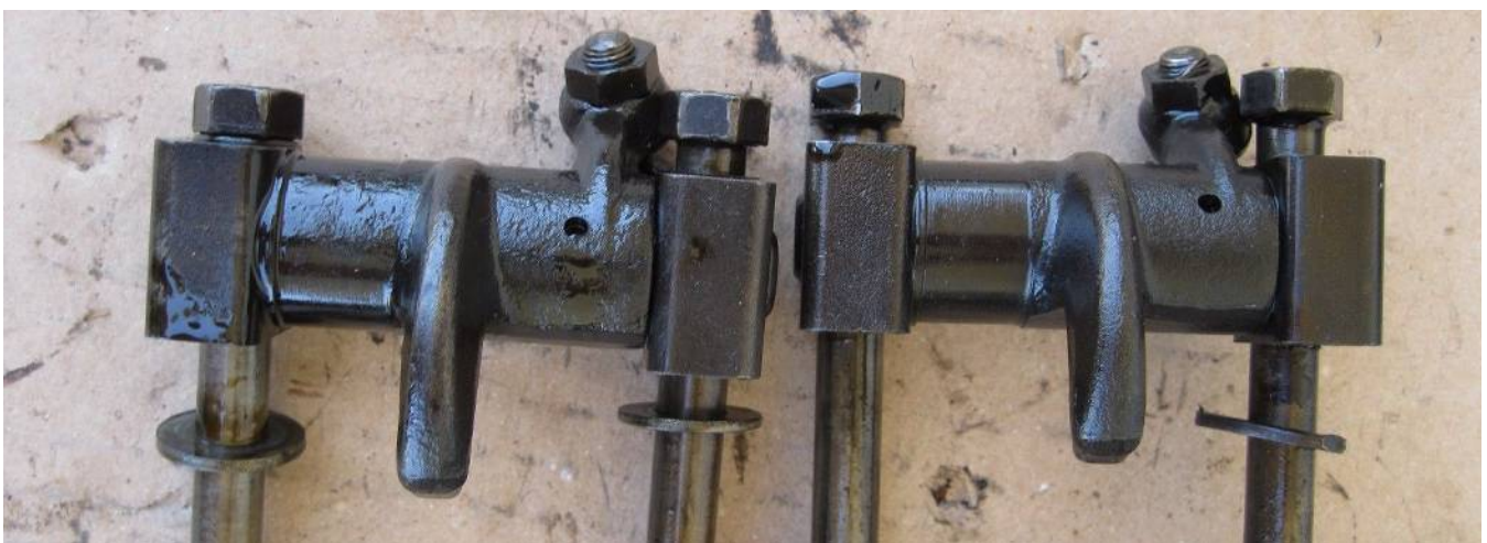
沈んだスリーブの帳尻を合わせるため部品設定のないワッシャーを挿入しないとクリアランスが調整できない
