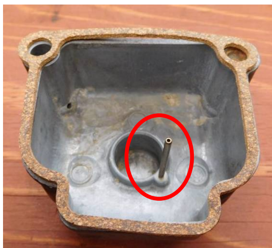
パイプに縦すじがあるとリークのリスクあり
