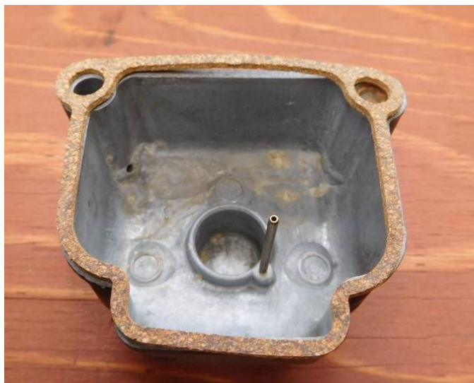
フロートの上にガスケットを載せてキャブ本体に合わせる
