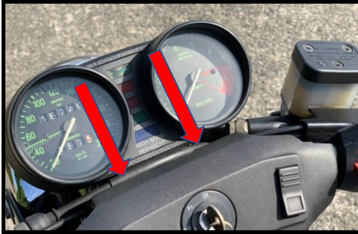
ドライバーを矢印の方向から差し入れますがメーターが邪魔で作業困難
