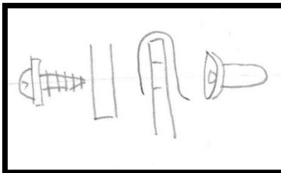
当初のネジ止め式 緩むと外れる
