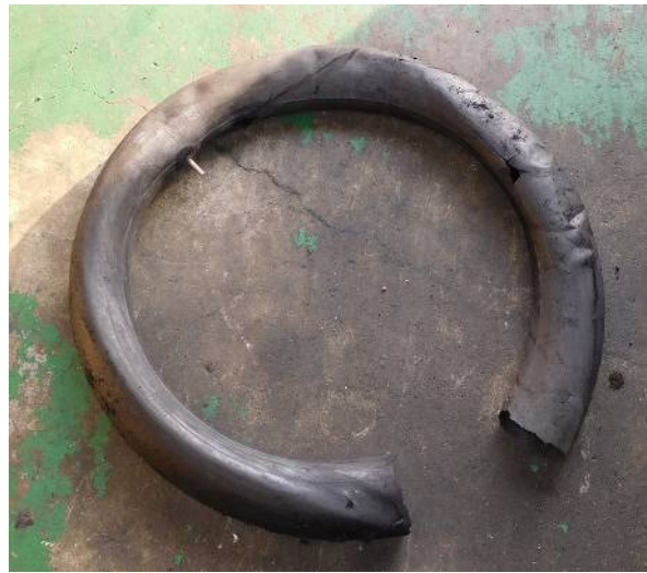
見事にチューブが破断されていた
