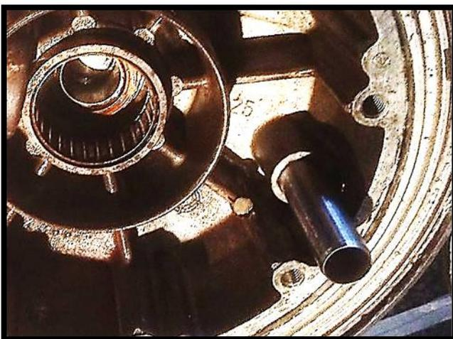
貫通パイプを圧入しオイルを遮断してドライなブレーキを獲得
