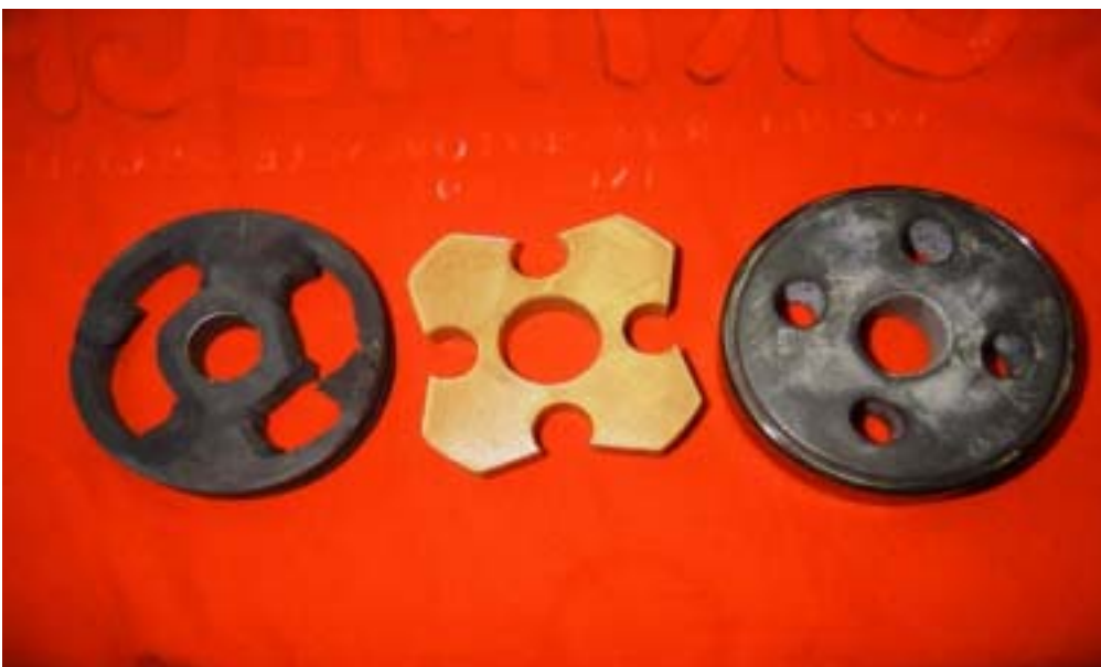
左：強度不足で破損 中央：対策品 右：同寸法のウラルノドニエブル用
