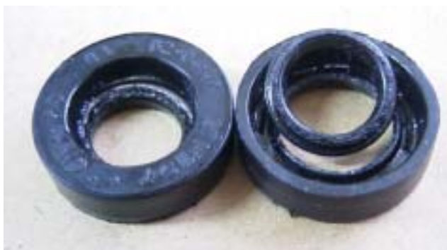
FIG. 08 オイルシール破損例
