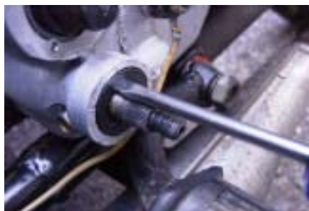
FIG. 02 マイナスドライバー差込み
