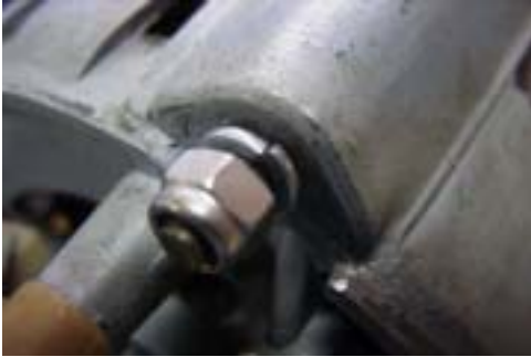
FIG.03 緩み止めナットとワッシャーの交換
