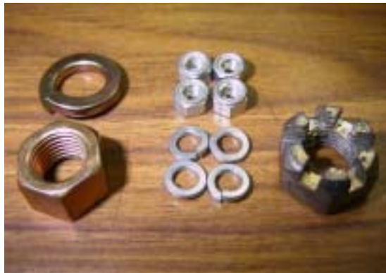
FIG.08 交換部品およびロシア製キャスルナット（右端）
