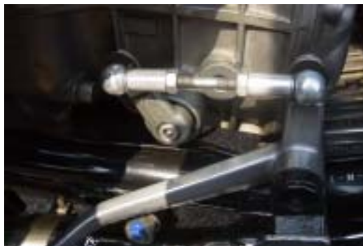
作動時に曲げモーメントが掛かり金属疲労が発生する
