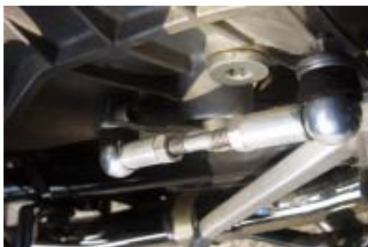
モノサス ピロボール式（かしめ固定）調整可能
