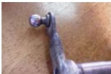
かしめタイプ修理例 TIG溶接
