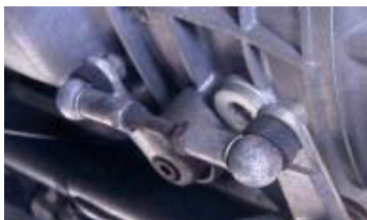
ナット固定式 肉厚なので折損しない
