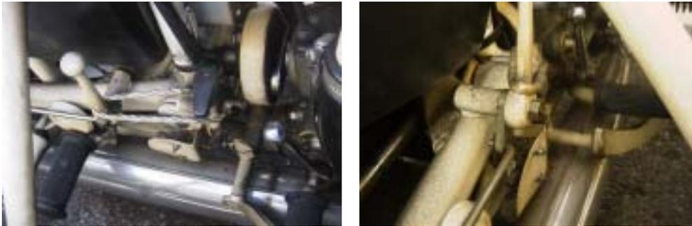
工作機械のハンドルやレバー、BMWサイドカーのホイールスピナーなどは意図的に重量配分を変えて共振による緩みを防いでいます。ウラルのセレクトレバーもこの方法が利用でき、効果があります。下図のようにレバー位置を組み替えることでレバー本体の重量により誤動作は発生しなくなります。また、この状態でレバーを持ち上げれば容易に2WDポジションに切り替えることが出来ます。
