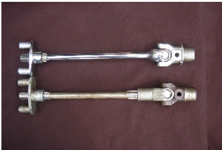
上：ロシア製純正品 下：ドイツ製シャフトにドニエブルの部品を組み合わせたもの
