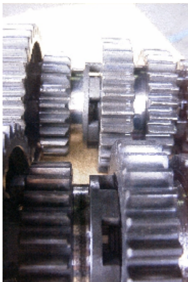
上： 未対策品 下： 対策品 ドッグのベースが厚くなっている
